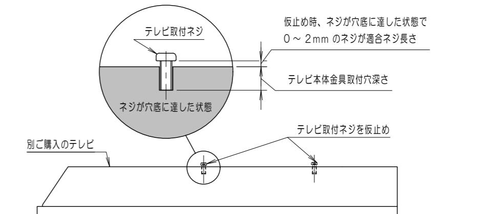
テレビ本体にネジを仮止めし、上図の寸法(0~2mm)に適合したネジをご使用ください。
